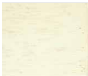
OHNE Isoliergrund verfärbt sich die Oberfläche gelblich.
